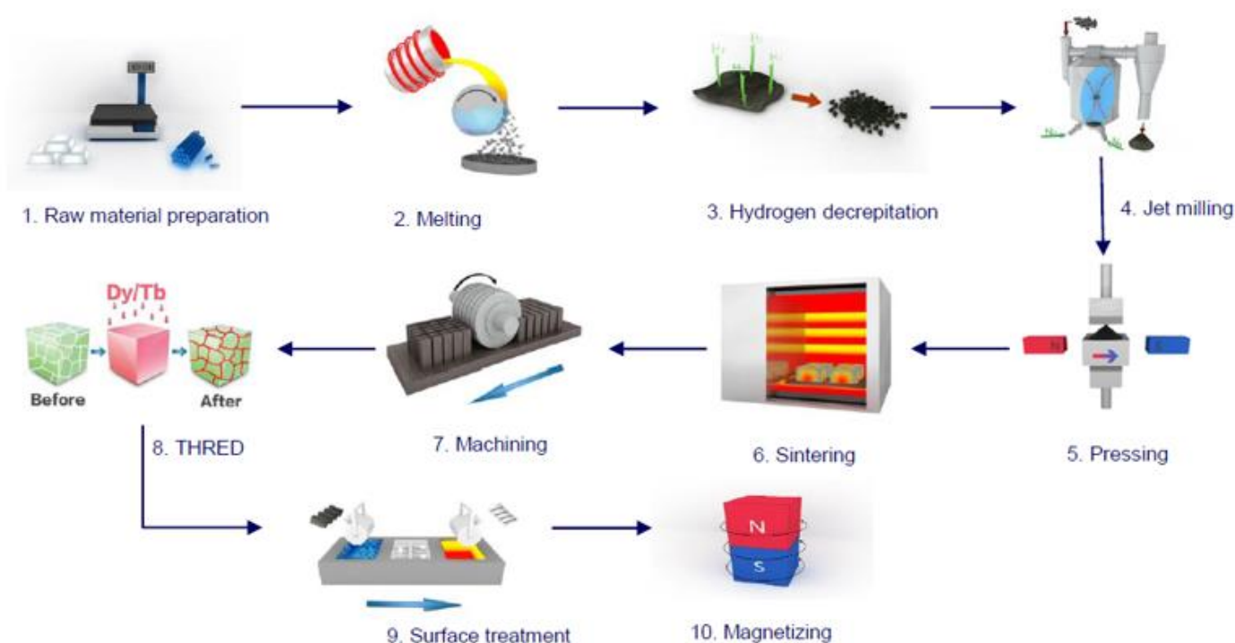
Figura 23: Visão geral do processo de fabricação de ímãs
